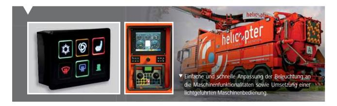
Neue Beleuchtungsoptionen ermöglichen es, Schaltfunktionen und Maschinenzustände differenziert anzuzeigen. Je nach Einsatzbereich kann entweder auf eine Segmentbeleuchtung oder auf eine zeitgemäße Ringbeleuchtung zurückgegriffen werden.
